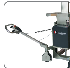
Die Deichsel kann gedreht und festgestellt werden. Der Anwender hat freien Zugang zum Inhalt der Gitterbox oder des Kastens.
