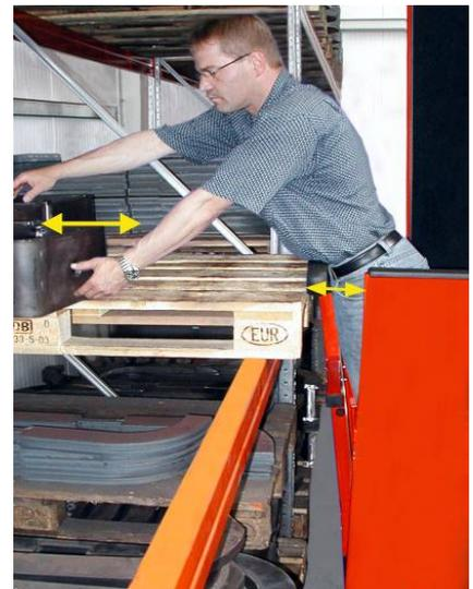
Mit den optional lieferbaren herausklappbaren Seitenschranken wird die Kommissionierleistung erhöht und der Rücken des Fahrers geschont.
