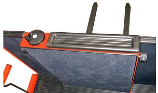
Als Zubehör ist eine beidseitige Bedienung mit und ohne Lenkung verfügbar. Damit ist das Fahrzeug jederzeit in beide Fahrrichtungen bedienbar.
