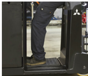
Schwebend aufgehängter Fahrerstand.
