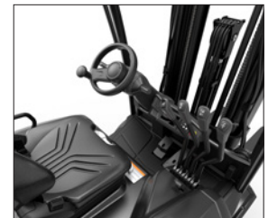
Hydraulische Steuerung mit Handhebel
